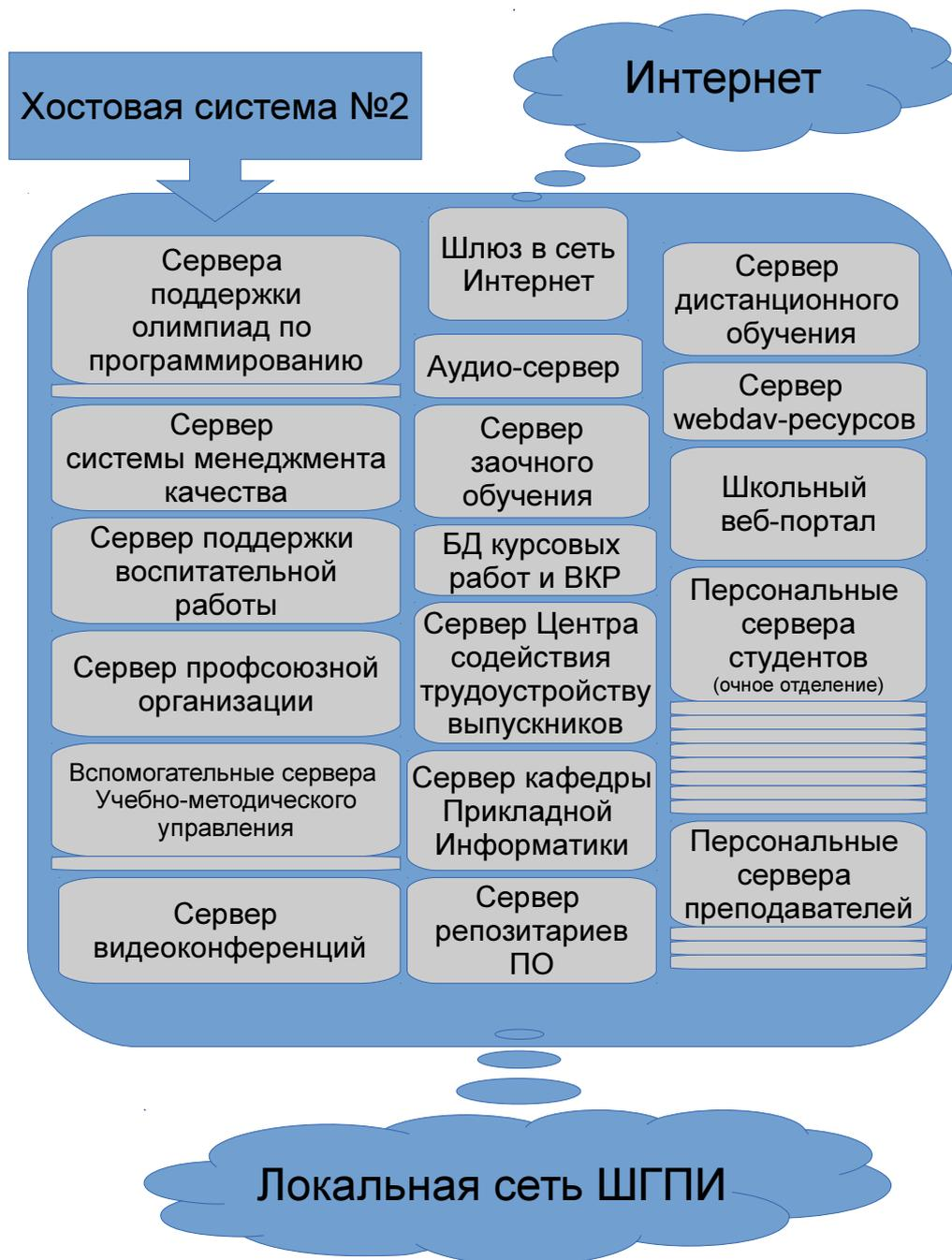
Схема 2. Структура и содержимое физического узла `hnode2.vc.shgpi`
