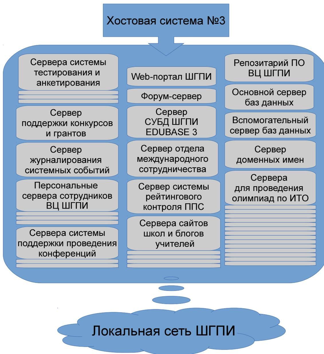
Схема 3. Структура и содержимое физического узла hnode3.vc.shgpi
